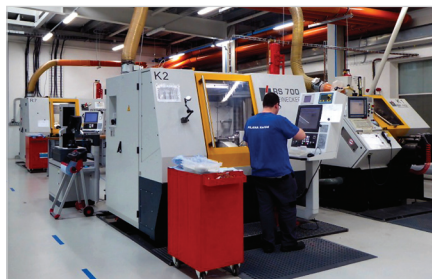
Uspořádání strojů v nové hale, kde postupně vznikají robotizovaná pracoviště – „hnízda“ ze tří až čtyř brusek.
